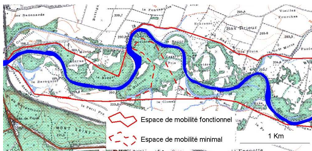
Figure 4. Vue d'une partie de l'espace de mobilité proposé sur la Loue aval (Malavoi, 2006 8 ). Les protections de berges existantes doivent être enlevées à court terme pour restaurer les processus géodynamiques naturels (érosion, dépôts...).
